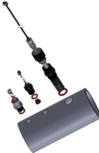
Abbildung 46 - Installation der Sonden an 3-Zoll-Rohrleitungen
